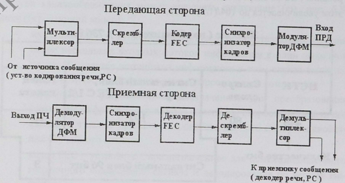
Рис. 6.8. Структурная схема аппаратуры каналообразования для каналов, использующих двукратную фазовую манипуляцию
